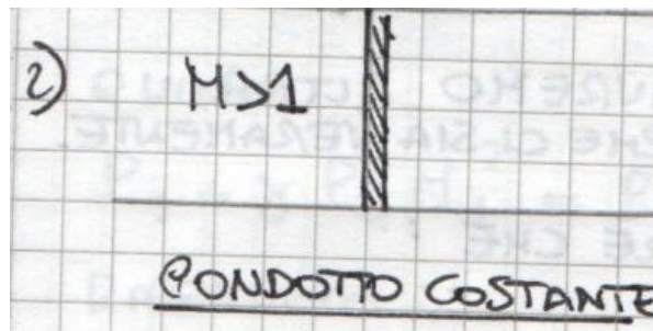
Figura 66: Diagramma di un condotto a sezione costante con un'onda d'urto normale. Il flusso è supersonico ( M > 1 ) a monte e subsonico ( M < 1 ) a valle. Il condotto è etichettato "Condotto costante".
