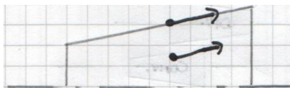
Figura 34: Diagramma di un condotto rettangolare con profili di velocità u e w mostrati come frecce parallele.
