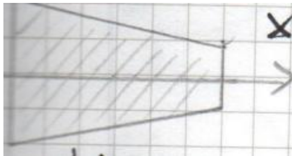
Figura 40: Diagramma di un condotto convergente. Una forma trapezoidale si restringe da sinistra a destra. Una freccia etichettata 'x' punta a destra. L'area è ombreggiata con linee diagonali.
