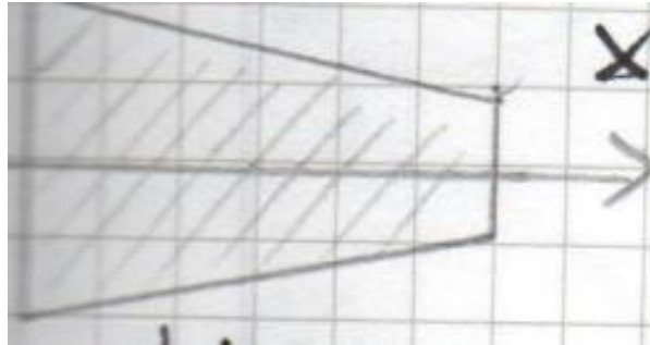
Figura 1.23: Condotto convergente: dA/dx < 0 .
