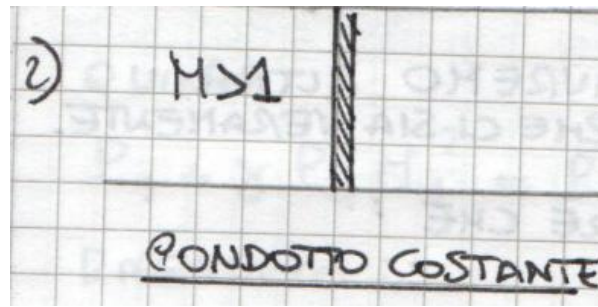
Figura 1.42: Urto in condotto a sezione costante: equilibrio indifferente (flussi di Rayleigh).
