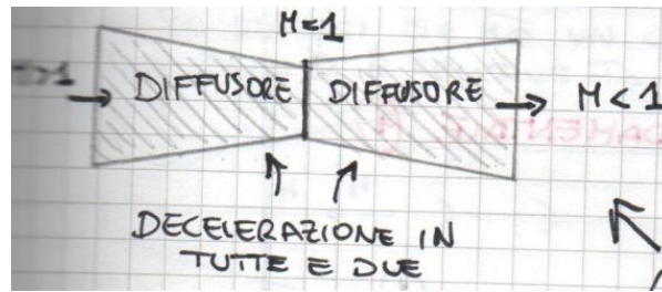
Figura 1.27: Diffusore supersonico-subsonico: il flusso entra con M > 1 , raggiunge M = 1 nella gola e decelera a M < 1 nella sezione divergente.
