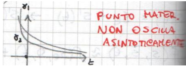
Figura 27: Andamento della perturbazione s'(t) nel caso di equilibrio asintoticamente stabile con radici reali negative: il punto materiale non oscilla e ritorna asintoticamente all'equilibrio.
