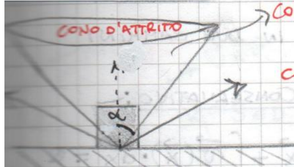
Figura 14: Cono d'attrito: la reazione vincolare totale \vec{R} deve restare all'interno del cono di semiangolo \alpha affinché il sistema permanga in condizioni statiche. L'asse del cono coincide con la direzione della reazione normale \vec{R}_N .
