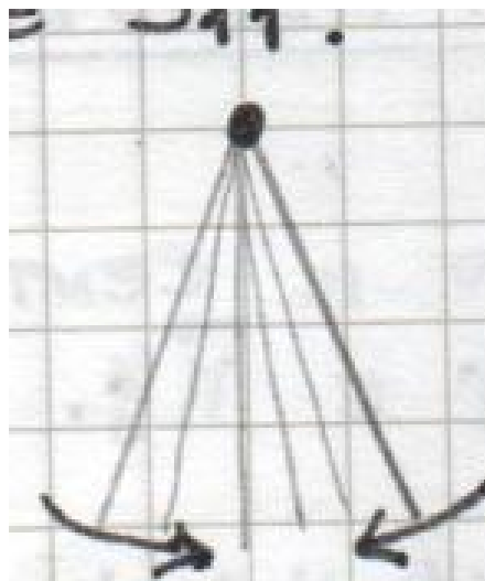
Figura 18: Configurazione di equilibrio del rombo per \Omega inferiore alla soglia critica: il pendolo resta vicino alla verticale.
