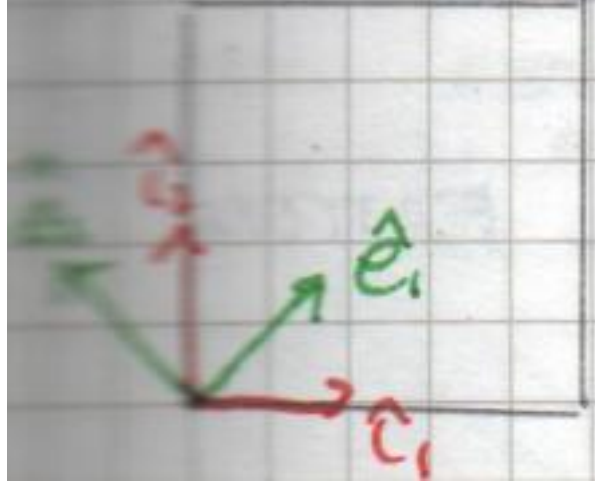
Figura 9: Lamina quadrata omogenea: gli assi principali di inerzia nel piano della lamina risultano ruotati di 45^\circ rispetto ai lati. Il centro di massa G coincide con il centro geometrico.
