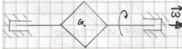
Figura 21: Lamina quadrata incernierata lungo una diagonale mediante perni fissi. La lamina ruota a \omega = \text{cost} attorno a tale diagonale.
